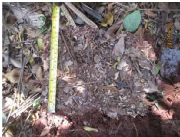
**Figura 4:** queda livre do bloco de solo, em bandeja plástica, a 1 m de altura do solo
