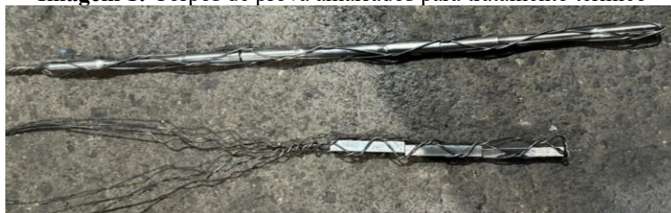
Imagem 1: Corpos de prova amarrados para tratamento térmico
