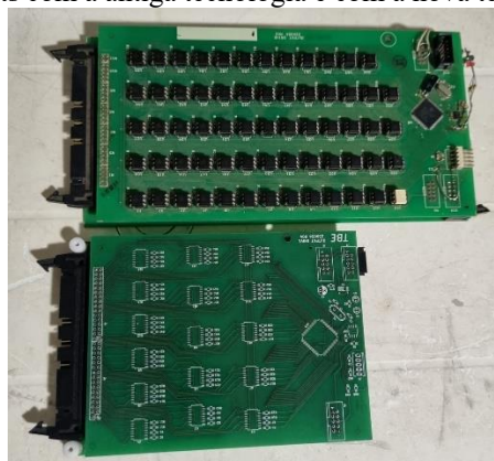
Figura 12: Slots com a antiga tecnologia e com a nova tecnologia (SMD)
