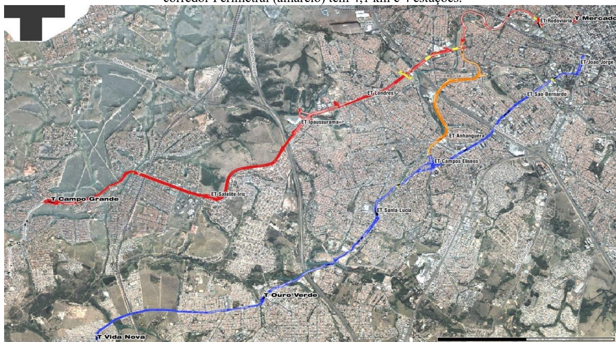
Figura 3: Corredores do BRT. Campinas possui três corredores do BRT: o corredor Campo Grande (vermelho) tem 17,9 km, 3 terminais e 17 estações; o corredor Ouro Verde (azul) tem 14,6 km, 4 terminais e 15 estações; e o corredor Perimetral (amarelo) tem 4,1 km e 4 estações.
